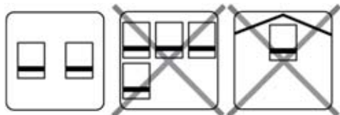
Figura 2.3 Assicurare una ventilazione adeguata
