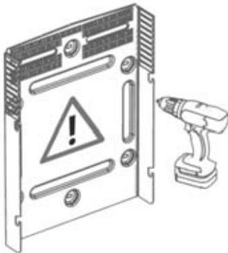
Imagen 2.10 instalación de la placa de montaje
