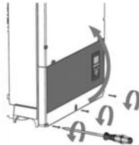
Abbildung 2.15 Vordere Schrauben lösen und Abdeckung anheben
