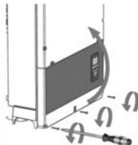
Figura 2. 15 Allentare le viti anteriori e sollevare il coperchio
