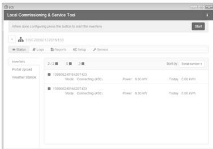
Figura 3.9 Tool LCS - Elenco degli inverter collegati a Inverter Manager
