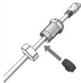
Figure 2.22 : Acheminez les câbles dans les presse-étoupe
