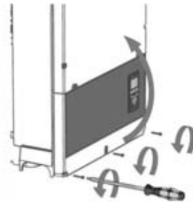
Figure 2.15 : Desserrez les vis avant et soulevez le couvercle
