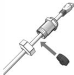
Figura 2.22 Far passare i cavi attraverso i passacavi
