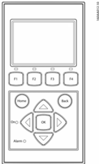
Imagen 3.1 información general sobre los botones y las funciones del display
