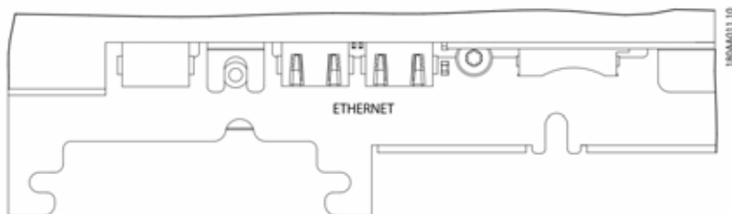
Figura 5.3 Interfacce ausiliarie (interruzione del circuito stampato di comunicazione con i connettori Ethernet RJ-45)
