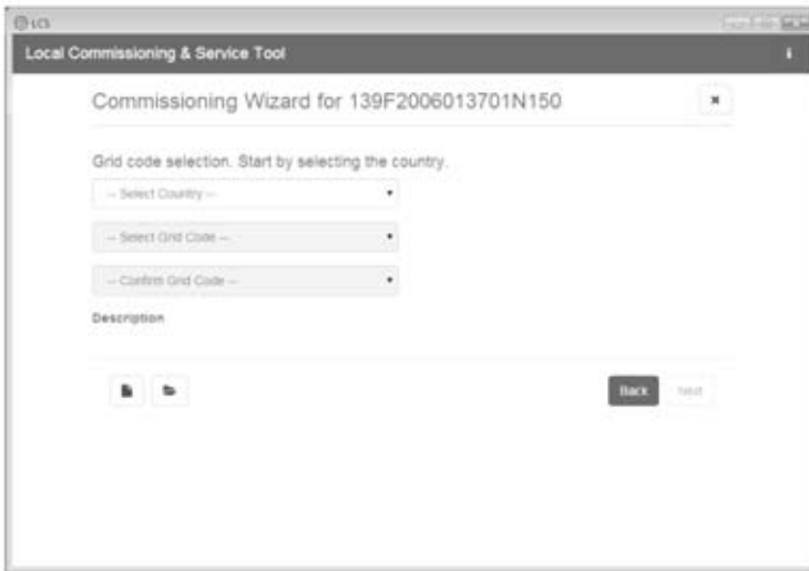
Abbildung 3.7 LCS-Tool - Land und Grid-Code auswählen
