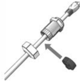
Abbildung 2.22 Kabelführung durch Kabelverschraubungen
