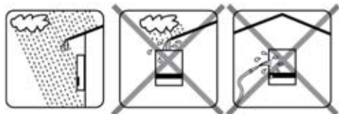
Figura 2.1 Evitare un flusso d'acqua continuo
