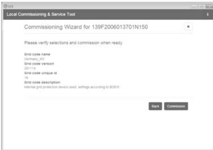
Abbildung 3.8 LCS-Tool - Überprüfung des Landes und des Grid-Codes
