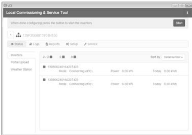
Imagen 3.9 herramienta LCS: lista de todos los inversores conectados al SMA Inverter Manager
