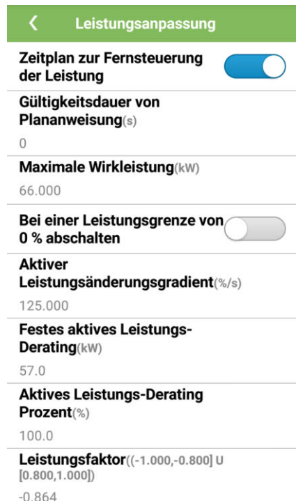
Abbildung 7-8 Leistungsanpassungsparameter (spezieller Benutzer)
