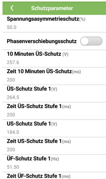
Abbildung 7-6 Schutzparameter (spezieller Benutzer)
