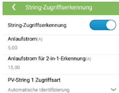
Abbildung 7-11 Zugangserkennung des PV-Strings
